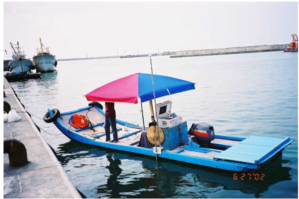
圖六、極小船隻單人測深之儀器配置
